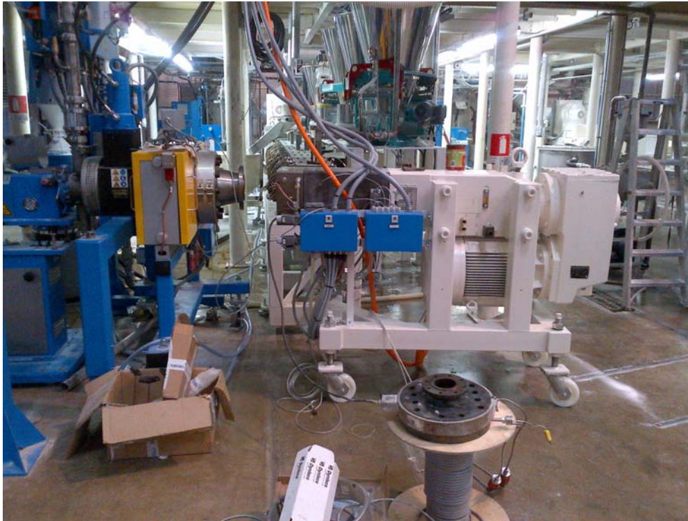
Abb. 6 Xtreamor® HMP 2-140 in 90° Anordnung als Ersatz für einen Einschnecke- naustragextruder
